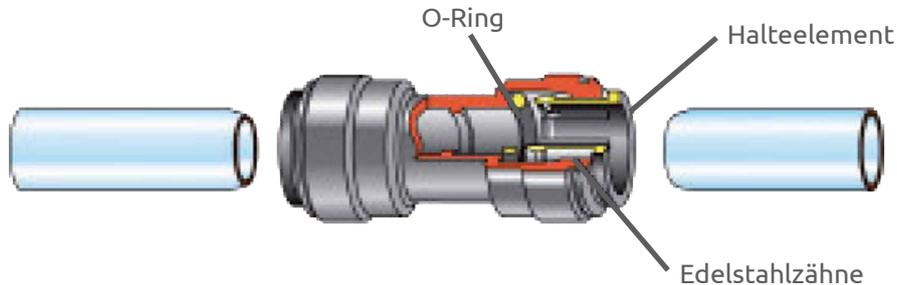
Der John Guest Verbinder besteht aus dem Verbinderkörper, Halteelementen mit Edelstahlzähnen sowie NBR-O-Ringen zur Abdichtung. Der Verbinder kann ohne den Gebrauch von Werkzeugen sowohl montiert als auch demontiert werden. Die Verbindung hält, bevor sie abdichtet!
