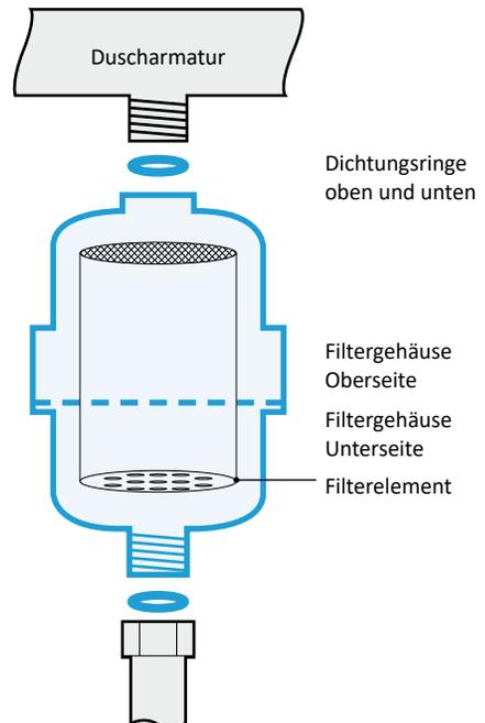
Regelmäßige Filterelementwechsel sind **Voraussetzung für die korrekte Funktion.**
