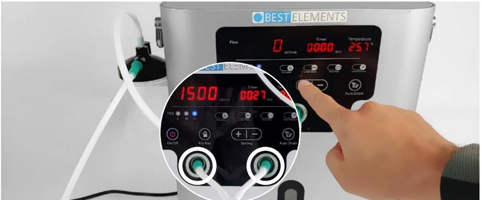
Der Wasserstoffgenerationsprozess beginnt. „Flow 1500 ml/min“ erscheint. Es leuchtet im Fenster blau und es steigen Bläschen auf. Es strömt nun ein Luftgemisch von **66% Wasserstoff aus der Öffnung  $H_2$  (1.000 ml/min)** und **33% Sauerstoff aus der Öffnung  $O_2$  (500 ml/min)** über die Nasenkanüle zusätzlich zu Ihrer Atemluft. Sie können  $H_2$  einzeln inhalieren oder mit beiliegendem Y-Stück kombiniert mit  $O_2$ .
