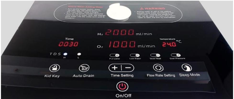
**Flussrate einstellen:** Die Menge der Flussrate kann über die Taste „Flow Rate Setting“ eingestellt werden.
