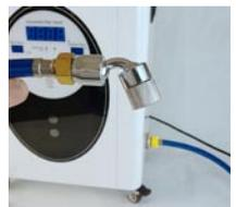
Mit Zudrehen des Wasserhahns stoppt die Wasserausgabe, das Gerät beendet die H<sub>2</sub>-Produktion automatisch. Nach Beendigung Gerät mit OFF ausschalten.
