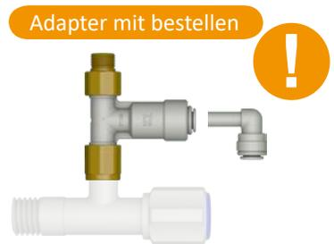
Beiliegendes Anschluss-Set ist komplett für aktuelle Eckventile. Bei älteren Eckventilen mit nur einem Ausgang 3/8" ist zusätzlich ein T-Stück mit Winkelstück erforderlich.
