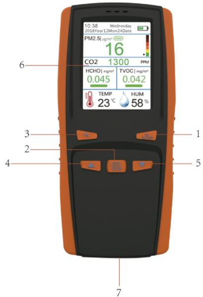
Die Ein-/Aus-Taste ca. 1 Sekunden gedrückt halten um Luftqualitätsmonitor zu starten. Der Detektor durchläuft eine Aufwärmphase von etwa einer Minute, damit die Sensoren vorgeheizt werden und der Lüfter frische Umgebungsluft ansaugen kann.
